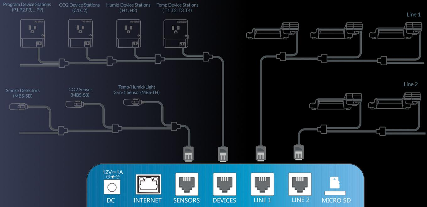
Il sistema è dotato di un sensore 3-in-1 di rilevamento di temperatura, umidità e luce.
